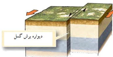
شکل ۲-۵: گسل معکوس با زاویه شکست بزرگ
