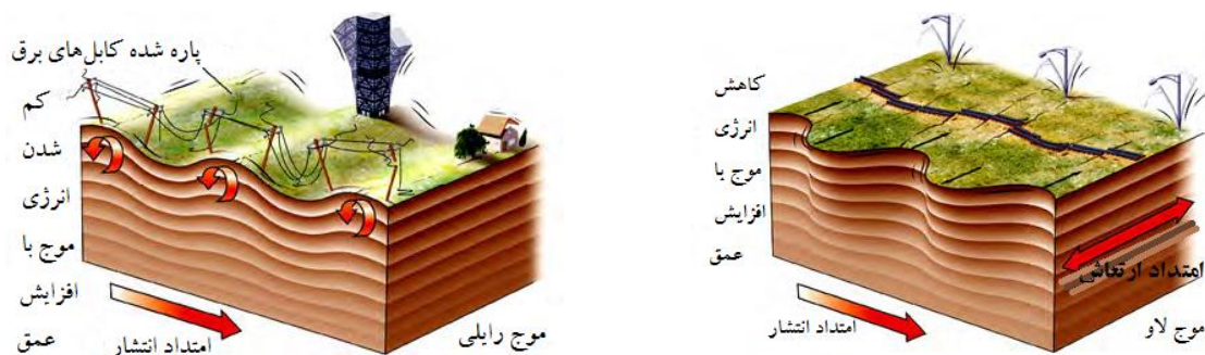
شکل ۱۵: نوسانات ایجاد شده بر اثر موج سطحی لایو شکل ۱۶: نوسانات ایجاد شده بر اثر موج سطحی رابلی
