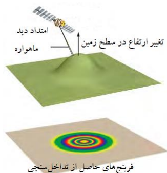
شکل ۲۴: تعیین تغییرات ارتفاعی بکمک فرینج‌های حاصل از تداخل‌سنجی ماهواره‌ای
